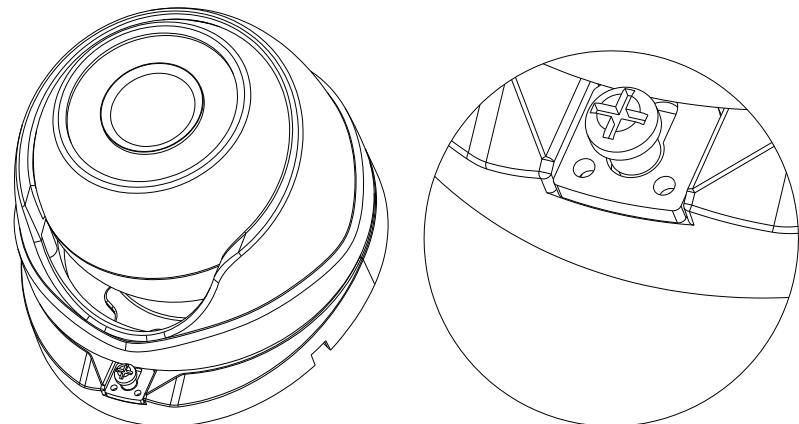
Рис. 4.4.1.6. Крепление видеокамеры LTV-CDH-B9001L-V
