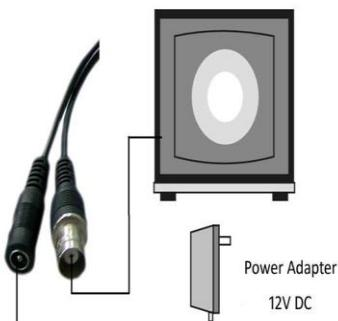
Рис. 5.1. Коммутация разъемов видеокамеры
