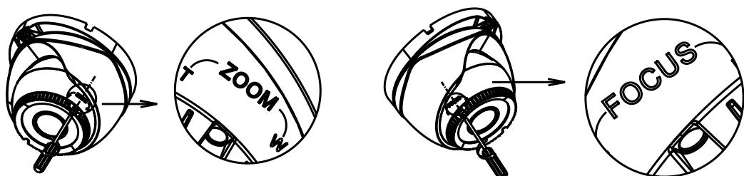
Рис. 4.4.1.5. Фокусировка объектива видеокамеры LTV-CDH-B9001L-V
