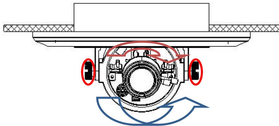
Рис.3.4.2.6. Настройка видеокамеры
