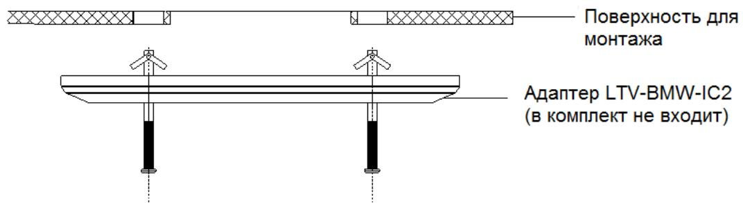
Рис.3.4.2.4. Крепление адаптера LTV-BMW-IC2 на потолок / стену
