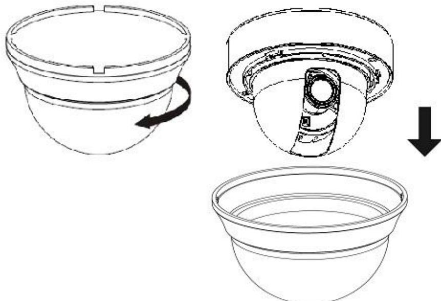
Рис.3.4.1.1. Снятие защитного колпака
