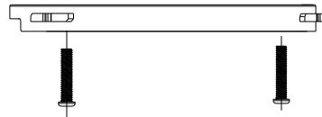
Рис. 3.4.1.3. Крепление монтажного основания видеокамеры на потолок / стену
