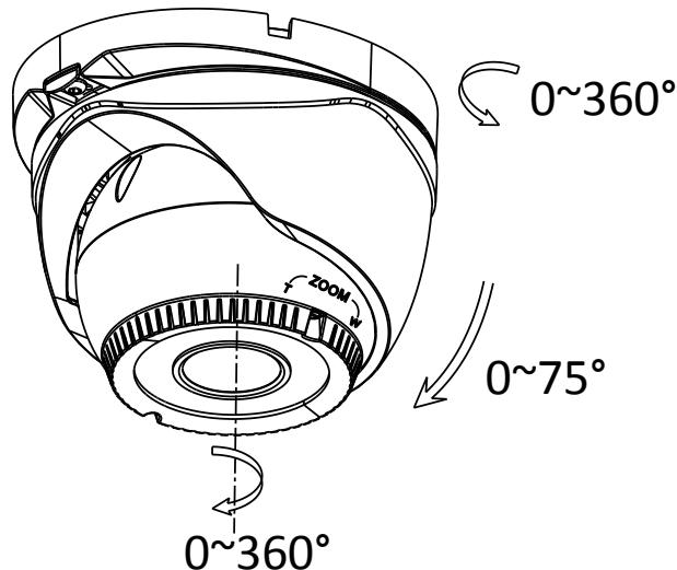
Рис. 4.4.1.4. Крепление видеокамеры LTV-CDH-B9001L-V
