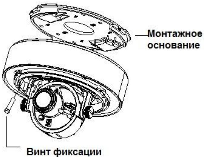
Рис. 3.4.1.4. Крепление и фиксация видеокамеры на монтажном основании
