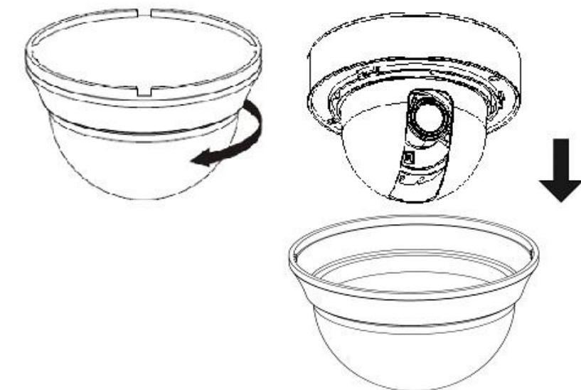
Рис.3.4.2.1. Снятие защитного колпака
